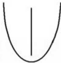
Fig 2. Grieta de Corazón
